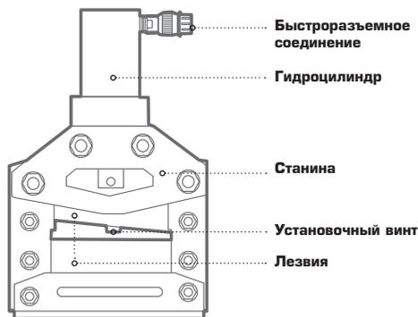
Гидравлический пресс состоит из гидроцилиндра и станины, на которой закреплены лезвия. Установочным винтом регулируется горизонтальность разрезаемой шины.
